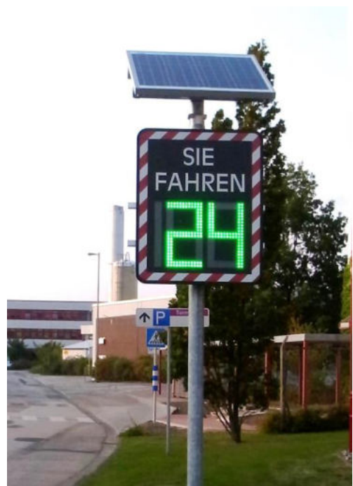
Foto zeigt Geschwindigkeitsanzeige mit Solarpanelle
