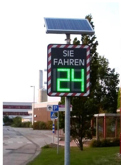
Foto zeigt Geschwindigkeitsanzeige mit Solarpanelle
